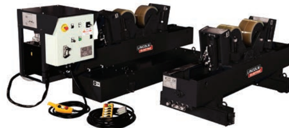
Version mit Automatik und zentraler Hydraulik
