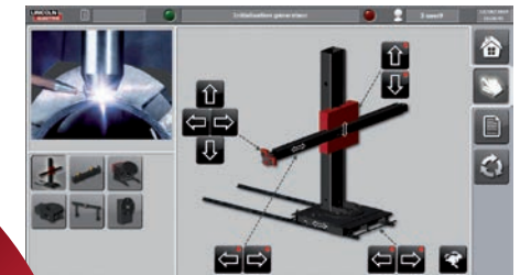
Graphische Anzeige von Anlage und Schweißkopf
